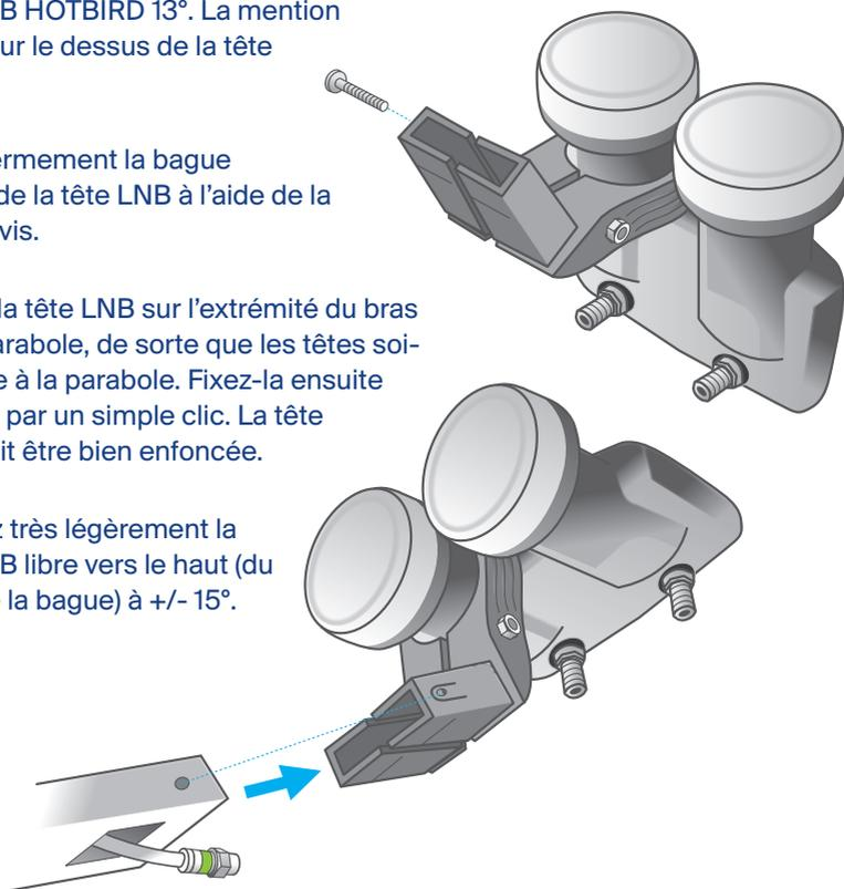
E. Insérez le câble coaxial dans le caoutchouc fourni avec la tête LNB, par l'ouverture la plus étroite.
