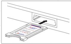
Einfach Modul in den CI+ Steckplatz des Fernsehers oder SAT-Receiver einstecken - fertig!
