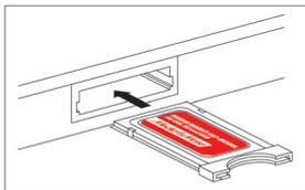
Einfach Modul in Pfeilrichtung in den CI+ Steckplatz des Fernsehers oder SAT-Receiver einstecken - fertig!
