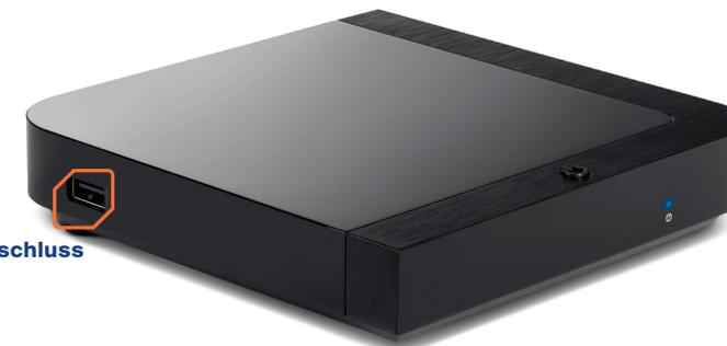
**Hinweis:** Nicht alle USB-Massenspeichergeräte sind für die Verbindung mit dem MZ-102 geeignet. Wir empfehlen eine mit USB 2.0/3.0 kompatible Festplatte für eine optimale Konnektivität.
